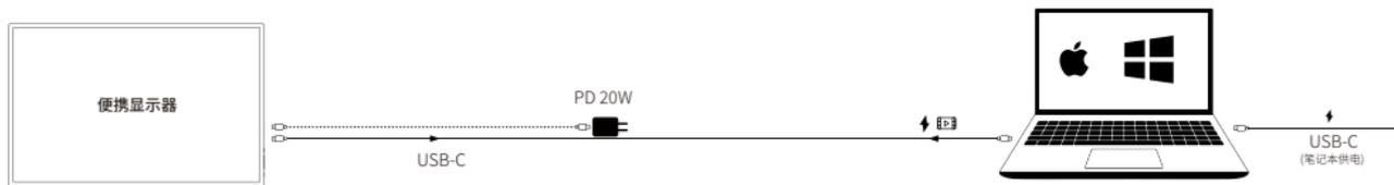
☆Type-C连接Mini PC接线示意图(电脑Type-C端,需要支持音视频全功能传输)
