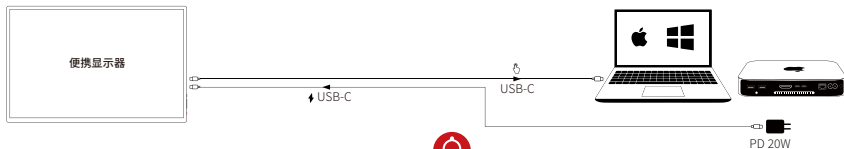
☆Type-C端口连接笔记本/Mini PC接线示意图
